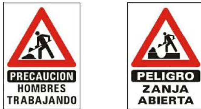
Figura 5. Modelos de cartelería a colocar en la zona de obras, zanjas.
