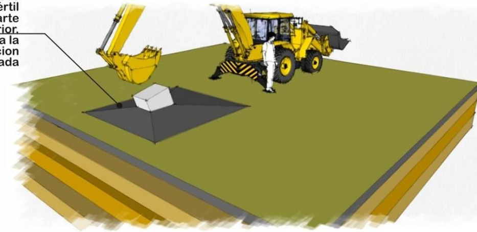
Figura 12. Compactación del suelo para fijación de bases. Fuente: Interconexión en 500 kV ET Santa Cruz norte – ET La Esperanza.
